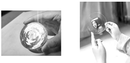
图 1. 用培养皿制作的银镜 图 2. 在表面皿上得到的“哈哈镜”
